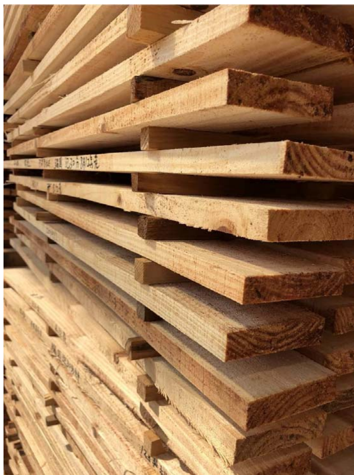
微乳液型有机防腐防霉剂处理后的木托盘原料可显著抑制霉变
