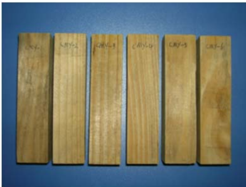
抗流失硼基防腐处理技术处理的马尾松经过9个月野外白蚁试验后图片 (未处理马尾松已全部蛀蚀)
